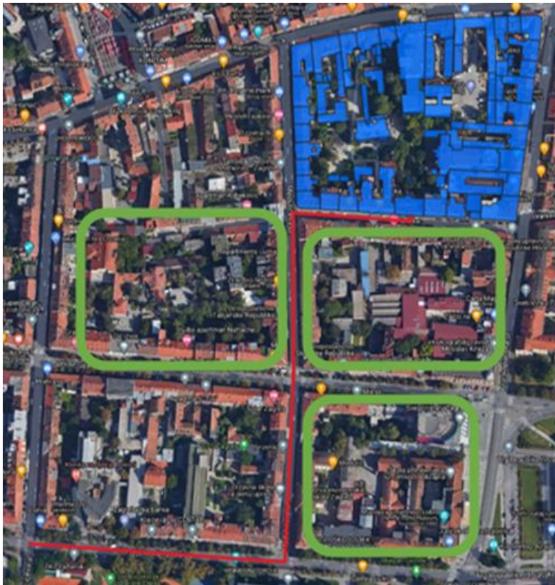
Slika 2 Primjer rješenja širenja postojeće toplinske mreže CTS-a Grada Zagreba (crveno – novi toplovod, plavo – Blok-19, zeleno – predloženi dodatni blokovi za spajanje)
